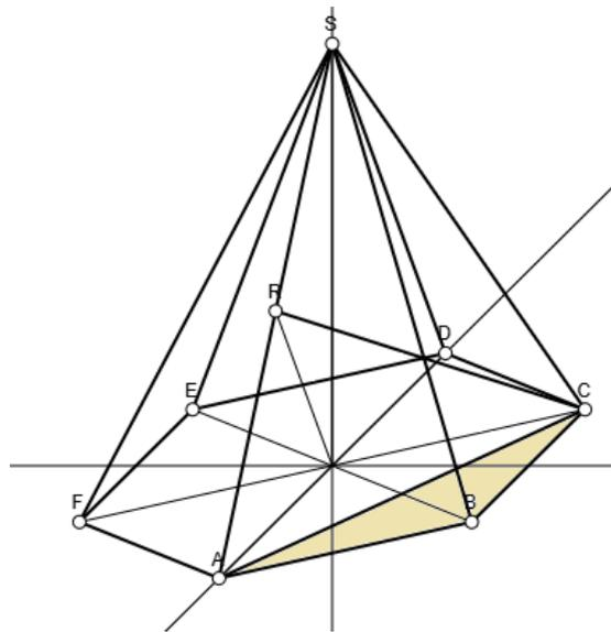
Das Teildreieck  $\Delta ABC$  der Grundfläche ABCDEF ist gleichschenkelig mit  $\overline{AB} = \overline{BC} = 8$  cm und dem Sechseckaußenwinkel  $\beta = 180^\circ - 60^\circ = 120^\circ$ . Die von der Ecke B ausgehende Höhe  $h_B$  halbiert das gleichschenkelige Dreieck  $\Delta ABC$ , es entstehen zwei rechtwinklige Dreiecke etwa mit  $\overline{AB} = 8$  cm als Hypotenuse,  $h_B$  und  $\overline{AC}/2$  als Katheten sowie dem Winkel  $\beta/2 = 60^\circ$ . Es ist somit:
