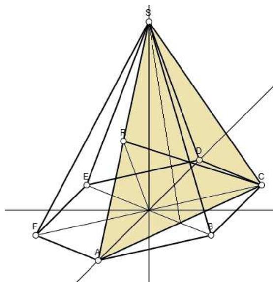
Das Dreieck  $\Delta ACS$  ist gleichschenkelig, die von der Pyramidenspitze S ausgehende Höhe  $h_1$  halbiert das Dreieck, im rechtwinkligen Dreieck aus Hypotenuse s, Kathete  $\overline{AC}/2$  und Kathete  $h_1$  errechnet sich der Winkel  $\alpha$  an der Pyramidenecke A als:
