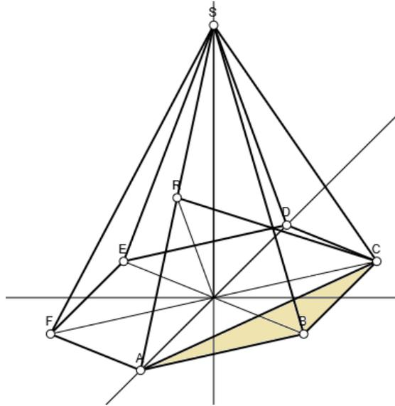
Das Teildreieck  $\triangle ABC$  der Grundfläche  $ABCDEF$  ist gleichschenkelig mit  $\overline{AB} = \overline{BC} = 8$  cm und dem Sechseckaußenwinkel  $\beta = 180^\circ - 60^\circ = 120^\circ$ . Die von der Ecke B ausgehende Höhe  $h_B$  halbiert das gleichschenkelige Dreieck  $\triangle ABC$ , es entstehen zwei rechtwinklige Dreiecke etwa mit  $\overline{AB} = 8$  cm als Hypotenuse,  $h_B$  und  $\overline{AC} / 2$  als Katheten sowie dem Winkel  $\beta/2 = 60^\circ$ . Es ist somit:
