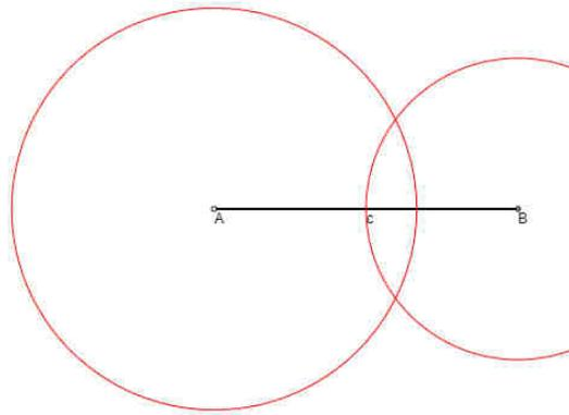
Schritt 4: Der Schnittpunkt der Hilfskreise  $k_A$  und  $k_B$  ist die Ecke C des Dreiecks.
