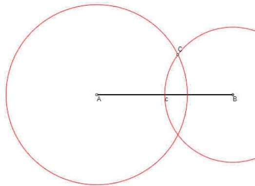
Schritt 5: Verbinde die Ecke C mit der Ecke A des Dreiecks; die Strecke zwischen A und C ist die Seite  $b = 8$  [LE] des Dreiecks.
